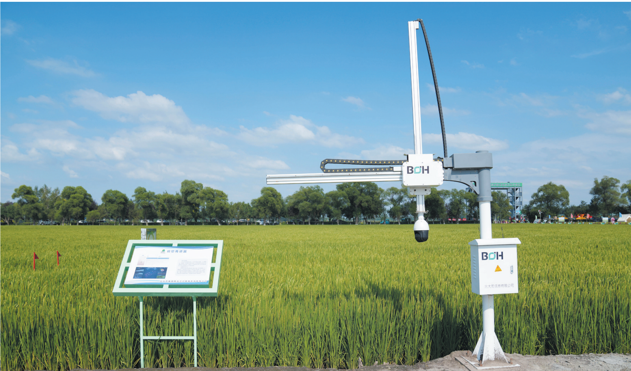
这是2023年8月10日在北大荒集团同家岗农场有限公司农业现代化示范区拍摄的利用数字技术的叶龄诊断仪。(新华社记者 王建威 摄)
