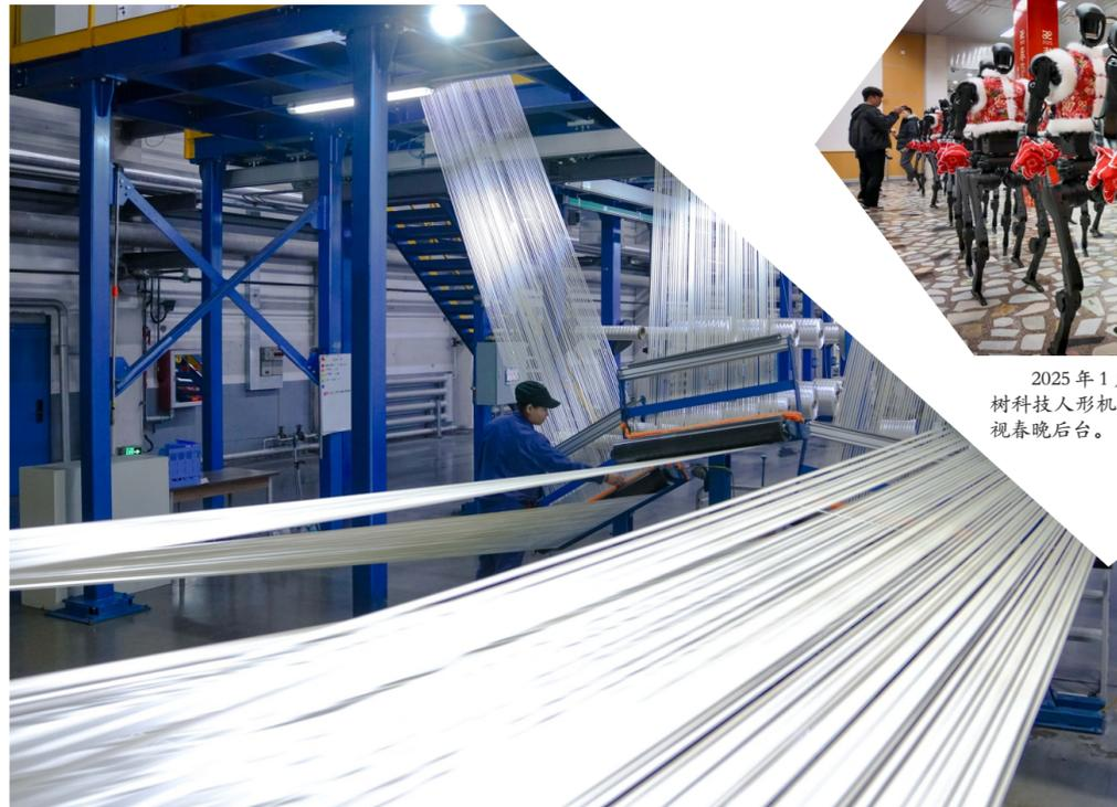
2025年2月2日，工人在吉林化纤集团国兴碳纤维有限公司碳化二车间整理碳纤维原丝。新春伊始，吉林化纤集团国兴碳纤维有限公司开足马力忙生产、赶订单。
