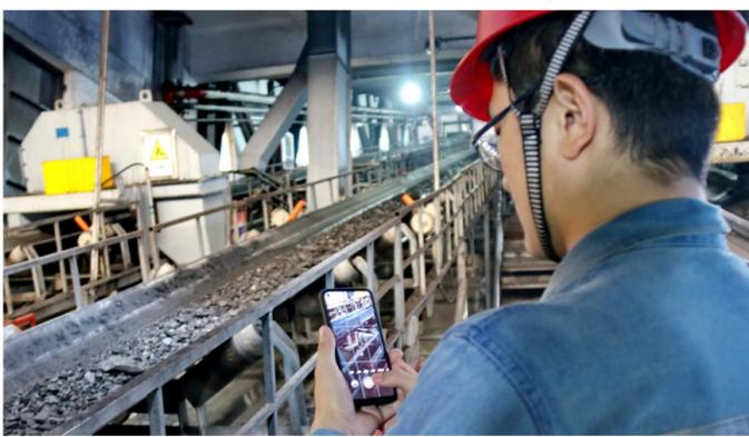
式。高清摄像头与计算设备的联动,使系统能够精准识别堆煤厚度、脱介筛筛板脱落、层叠筛跑粗等细微异常;科技赋能安全,厂房构建动态电子围栏,设备启动时生成安全禁区,实现从“被动防护”到“主动护航”;AI智能识别系统成为“电子哨兵”,实时识别人员、系统不安全状态,并通过手机APP将现场画面等同步推送至责任人;智能启停车诊断系统通过整合设备振动、温度、润滑油
